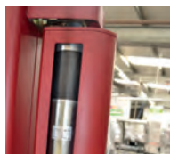
Moteur caché dans le montant
